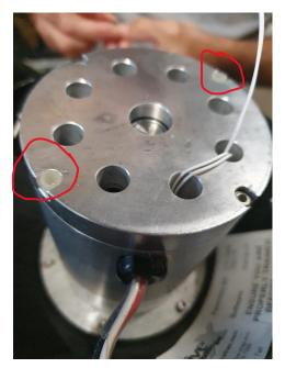
PUT BACK THE TOP , LET THE CONNECTION PLUG OF THE TEMPERATURE SENSOR OUTSIDE THE MOTOR
