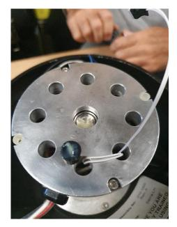
GLUE THE BACK OF THE MAGNET TO THE MOTOR AXIS
