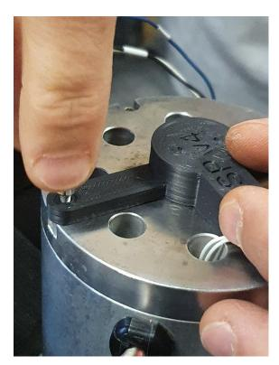
SCREW THE POSITION SENSOR TO THE MOTOR
